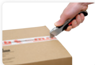
30% des blessures surviennent en fin de coupe, lorsque la lame quitte le produit coupé (source : CNAMTS). La conception évite ces accidents.
