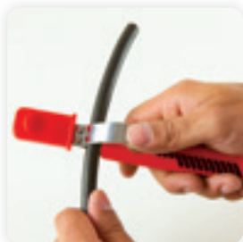
1 - Placer le dégaîneur avec une légère pression du pouce
